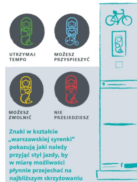
Rys. 8.3 Totem rowerowy oraz informacja o wyświetlanych sygnałach, Warszawa, Polska
