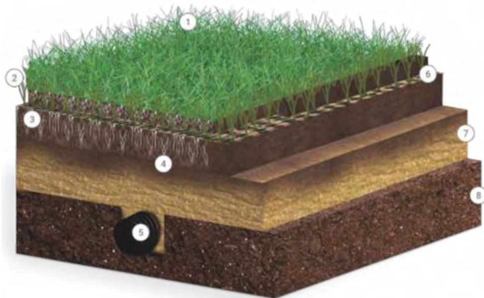
1. Trawa naturalna 2. Runo o wys. 50, 60mm 3. Warstwa wegetacyjna 4. Przerastanie 5. Drenaż 6. Tkana mata 7. Warstwa odsączająca 8. Grunt rodzimy
